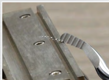
لبه برشی شماره ۵ تیغه MR-15 بر روی لبه صاف از جنس فولاد ضد زنگ (استیل)
