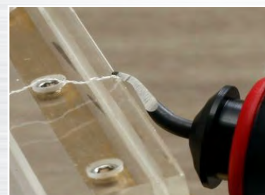
لبه برشی شماره ۲ تیغه MC-101 بر روی لبه صاف از جنس آلومینیک
