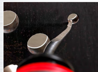
لبه برشی شماره ۲ تیغه MC-101 بر روی سوراخ کوچک از جنس فولاد
